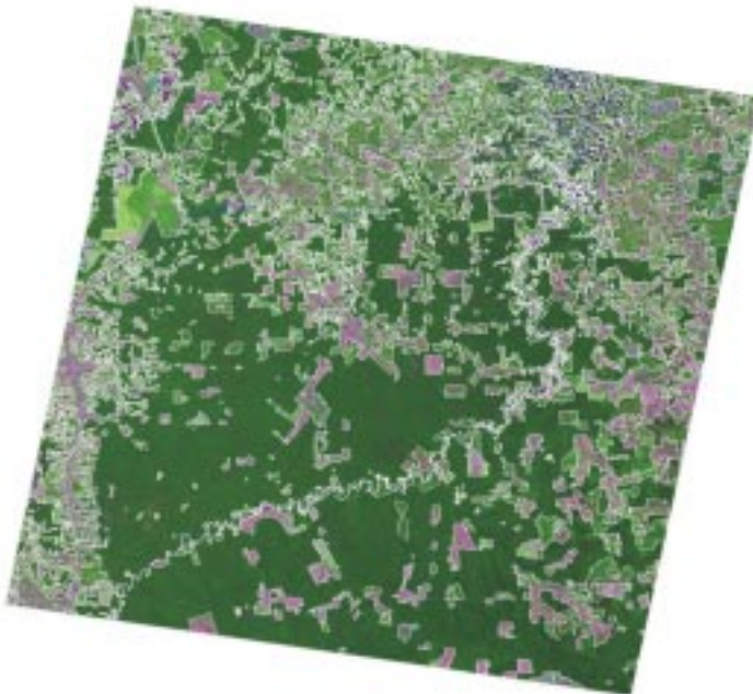
Fig. 3 As mesmas linhas de segmentação da figura 2 sobre a imagem colorida (R5 G4 B3) do sensor TM do satélite Landsat.
