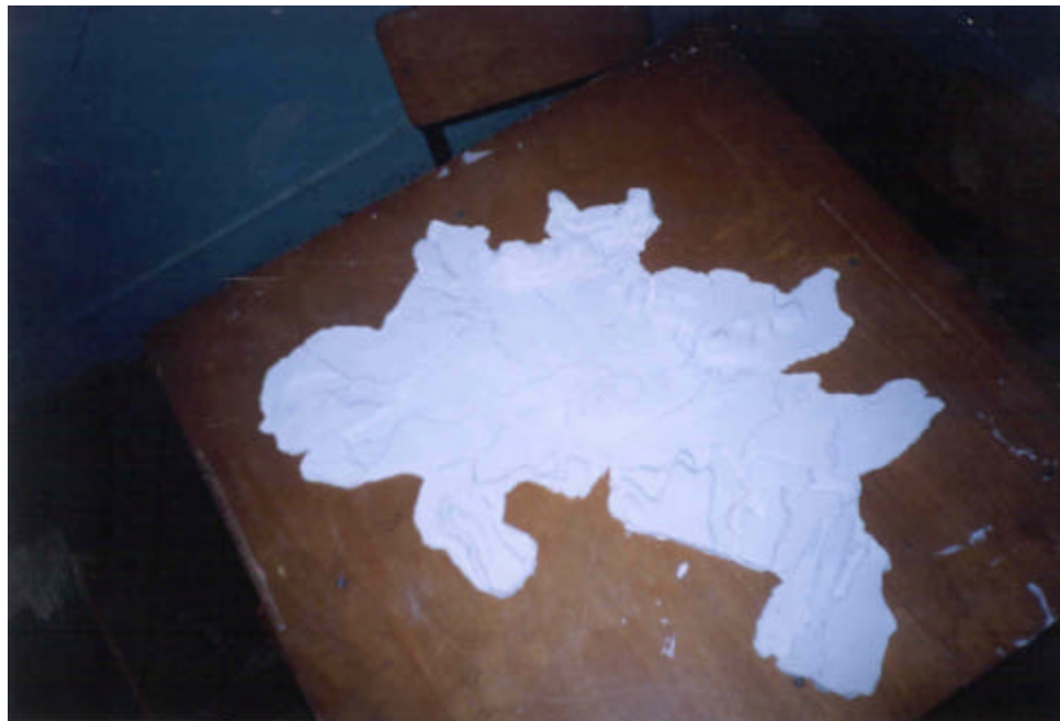
Foto 8 - Vista da Maquete com três aplicações de massa corrida – Região Norte
