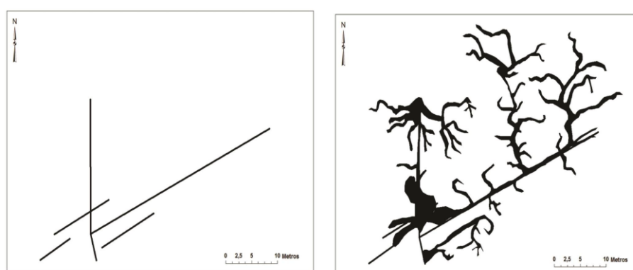
Figura 15. Esquema de fraturas e padrão dendrítico que se formou adjacente, onde o sistema cárstico é desenvolvido. Esquema desenvolvido a partir da Fig. 14D.
