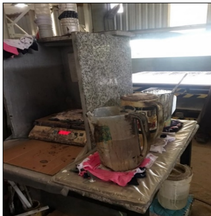
Figura 9 - Balança, jarras e vareta - materiais utilizados para a formulação dos sistemas epóxi.
