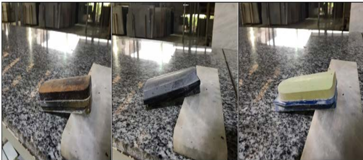
Figura 12 – A) - Peça de abrasivo diamantado; B) - Peça de abrasivo convencional; C) - Peça de abrasivo resinóide.
