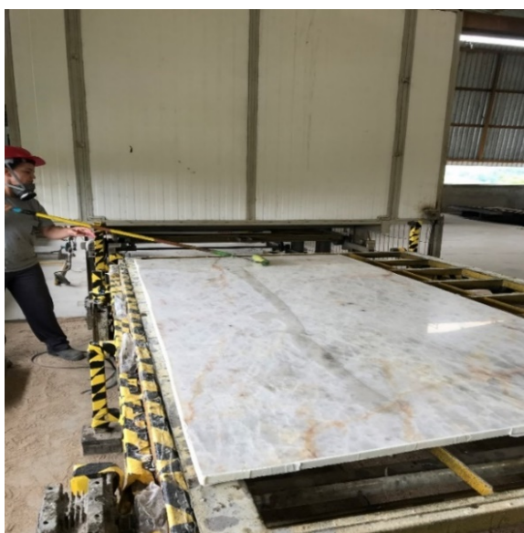
Figura 11 - Momento da aplicação do sistema epóxi com a utilização do rolo de espuma, em uma das chapas utilizada no experimento.
