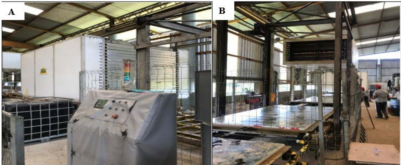
Figura 8 – A) - Vista para o forno de secagem da linha automática de resinagem. B) - Vista da linha de resinagem com destaque para o dispenser de gel.
