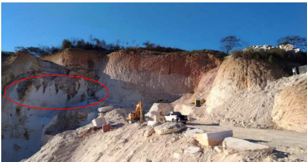
Figura 6 - Frente de lavra do veio de quartzo que corta um pegmatito. Notar para a parede do veio com infiltração (em vermelho).
