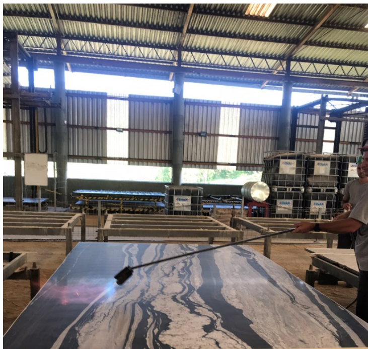
Figura 3 - Processo de aquecimento da superfície da chapa com a utilização do lança chamas "pela porco".
