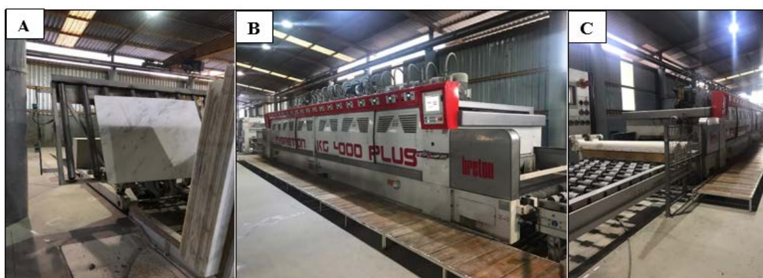
Figura 10 – a) – Robô de entrada da politriz. b) - Politriz Levibreton kG 4000 plus. C) – Mesa de transporte após a saída da politriz.
