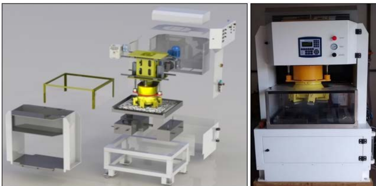
Figura 2 - Representação esquemática do equipamento S-PRO e imagem real.
