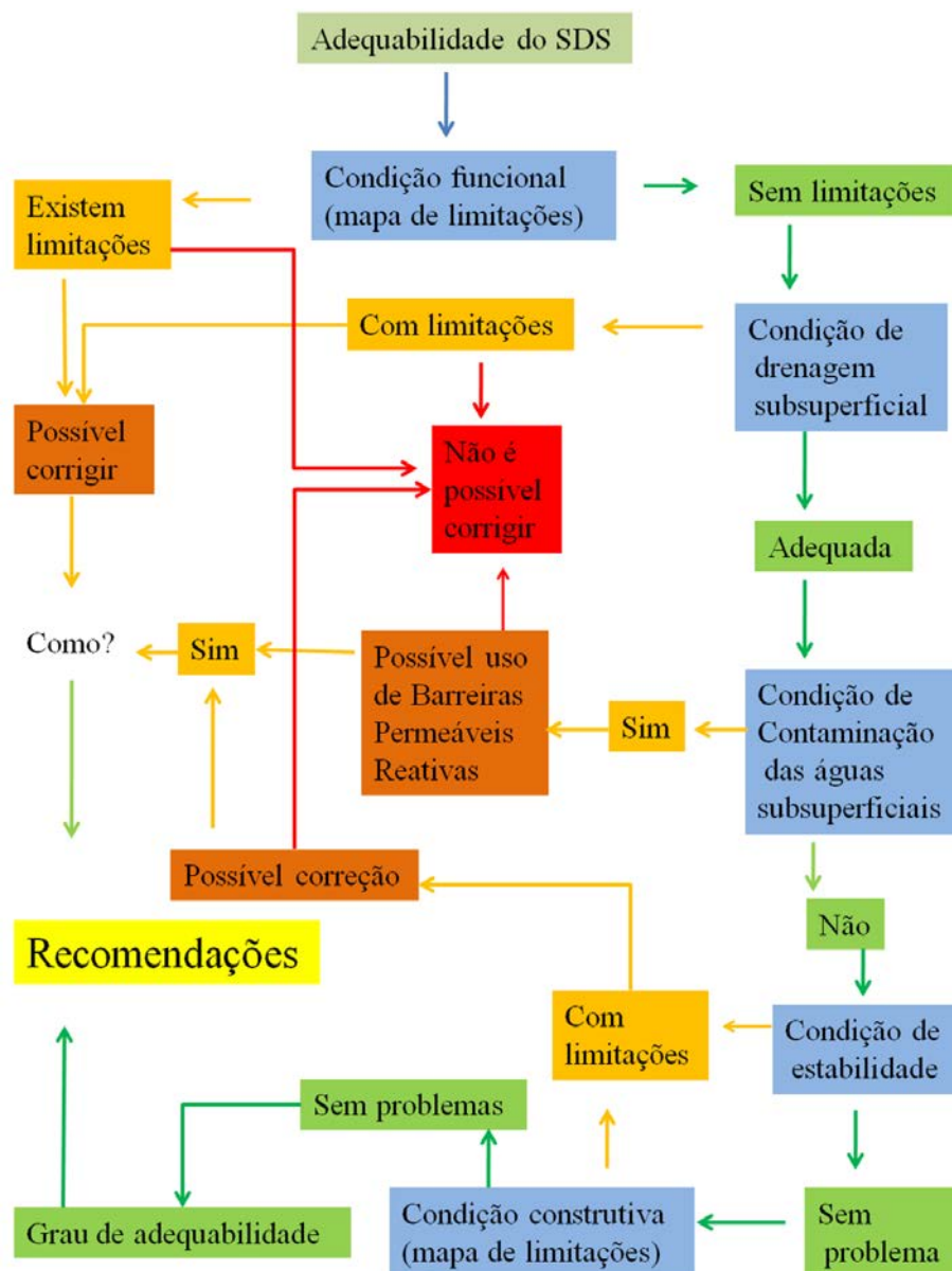
Figura 5 - Fluxograma usado para elaboração do zoneamento da adequabilidade para sistemas de drenagem sustentáveis (SDSs).
