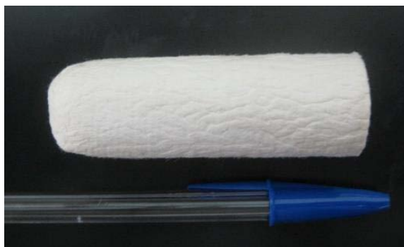
Figura 4. Cartucho do tipo Soxhlet fabricado com celulose.
