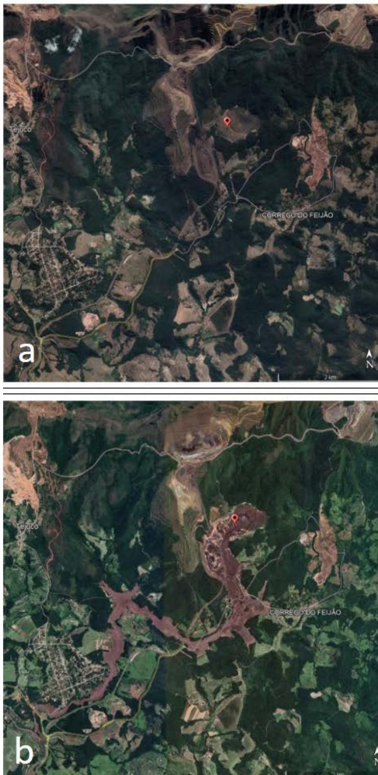
**Figura 1** – Imagens de satélite com comparação do local antes e depois do local do rompimento da barragem B1 (Fonte: Google Earth (08/2018; 02/2019)).
