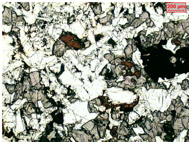
FOTO 5. Fotomicrografia da amostra KS 781 mostrando textura intergranular, com cristais tabulares de plagioclásio, granulares e acastanhados de piroxênio, avermelhados de óxido de ferro (pseudo-hematita) e minerais opacos. Nicóis paralelos.
