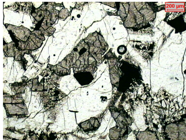
FOTO 6. Fotomicrografia da amostra KS 732. Textura subofítica, com cristais prismáticos de plagioclásio parcialmente envolvidos por piroxênios acastanhados. Nicóis paralelos.
