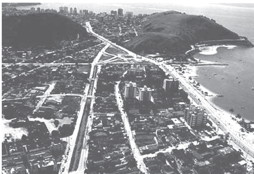
FOTO 1. Vista panorâmica da área da Ponta do Camaroeiro na porção norte da Enseada de Caraguatatuba. Notar estruturas rígidas perpendiculares à linha de costa e a sua interferência no transporte e distribuição de sedimentos.
