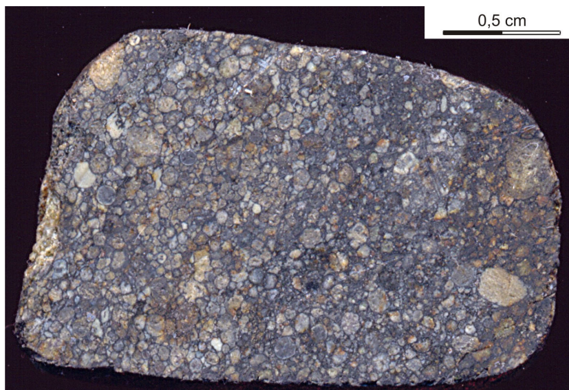
FOTO 2. Meteorito utilizado para análise, mostrando o corte feito para a obtenção de secção delgada, com 3,1 cm na horizontal e 2 cm na vertical.
