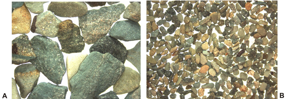
FIGURA 8. Fotografia dos grãos do verdete nas frações granulométricas (A) >1,68 mm e (B) -0,595 + 0,420 mm.
