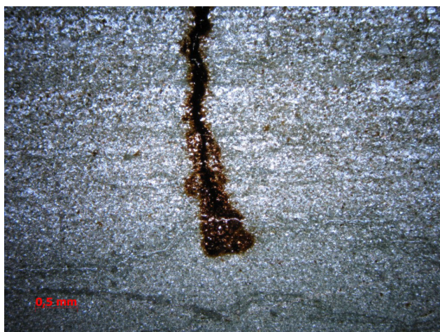
FIGURA 5. Preenchimento de fratura da Amostra AM-05 por óxido de ferro. Luz polarizada.
