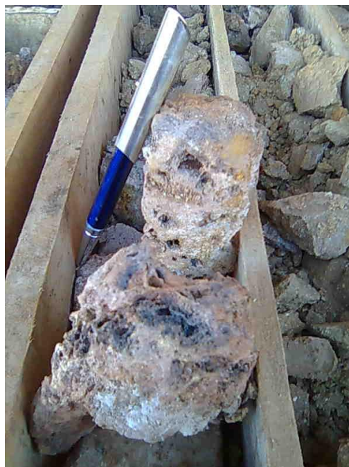
Figura 5. Testemunho de sondagem: silexito.
