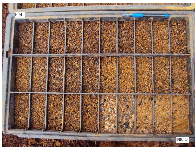
Figura 3. Amostras da perfuração do poço P-2, coletadas a cada metro, composta por silexitos.
