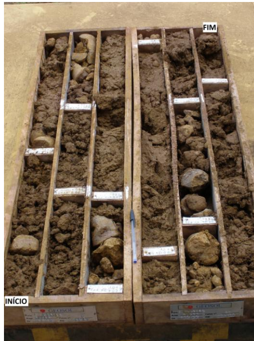
Figura 4. Testemunhos de sondagem com amostras variando de 0,5 a 1 metro de comprimento: saprolito marrom arenoso.
