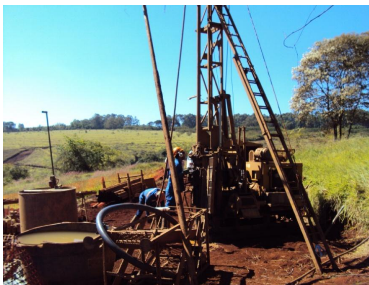
Figura 2. Sonda rotativa na área sudeste da intrusão.
