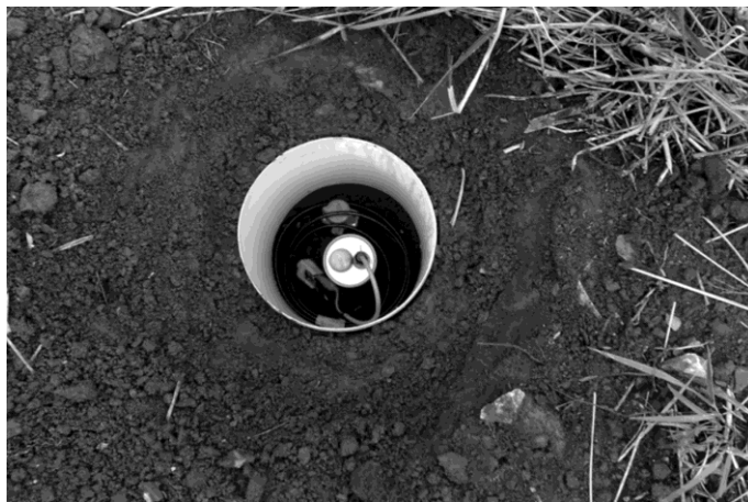
Figura 3. Foto do geofone e do registrador Texan instalados dentro da perfuração e protegidos pelo tubo de PVC.
