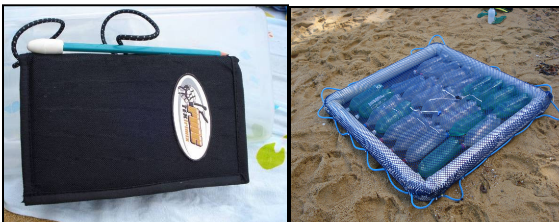
Figs. 7a e 7b: Wet Note usado para os censos visuais da fauna (à esquerda) e o flutuante (à direita) com reaproveitamento de garrafas pet para apoio no mar. Fonte: acervo do Projeto.
